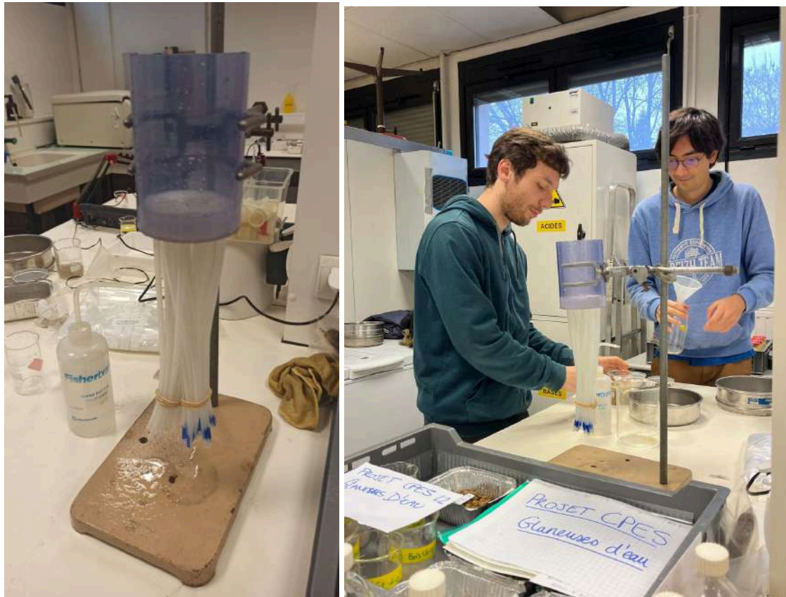
Figure 8 : La pieuvre, méthode de séparation d'une solution ou suspension en deux solutions ou suspensions de composition identique et de même volume.
